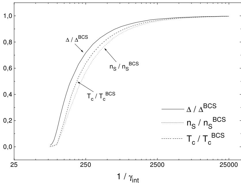
Рис. 1: Зависимости параметра порядка в сверхпроводнике  $\Delta$ , плотности сверхпроводящих электронов в сверхпроводнике  $n_S$  и критической температуры бислоя  $T_c$  от прозрачности границы на канал  $\gamma_{int}$  при нулевой температуре. Все величины нормированы на соответствующие БКШ-значения. Случай БКШ соответствует отсутствию эффекта близости, т.е. непрозрачной границе:  $\gamma_{int} = 0$ .
