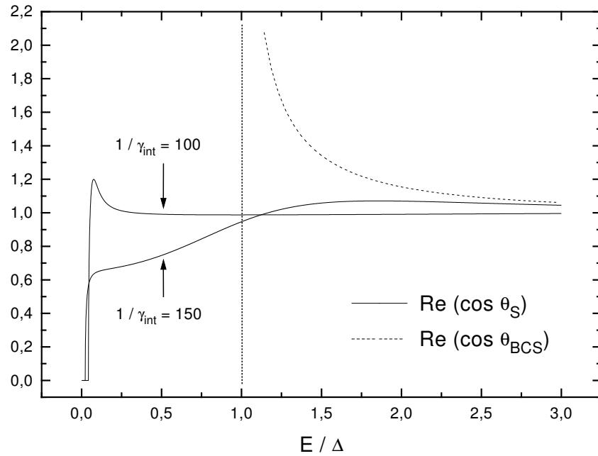
Рис. 5: Зависимость плотности состояний  $\nu$ , нормированной на плотность состояний на уровне Ферми,  $\nu(E/\Delta)/\nu_0 = \text{Re}[\cos \theta_S(E/\Delta)]$ , от энергии  $E$ , нормированной на  $\Delta$ , при  $1/\gamma_{\text{int}} = 100$  и  $150$ . Для сравнения показана плотность состояний в случае сверхпроводника БКШ:
