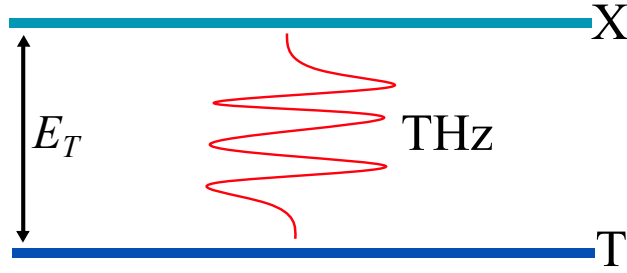
Рис. 4: Прямой переход из трионного состояния в экситонное под действием терагерцового электромагнитного поля.
